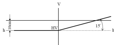
圖一 檢驗儀器光型螢幕 1
